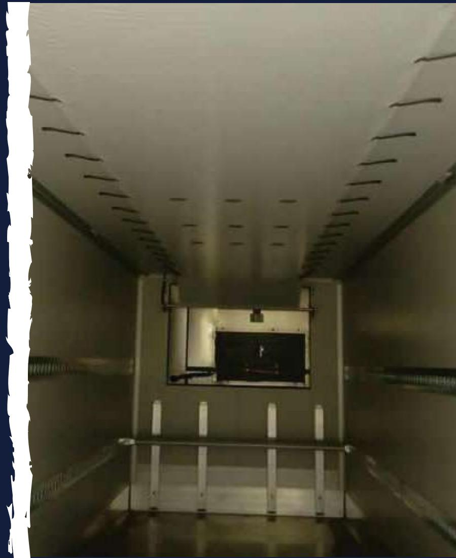
Las lonas para canalización de equipo frío están diseñadas específicamente para camiones con sistemas de refrigeración, asegurando que la carga mantenga una temperatura constante durante todo el transporte. Estas lonas se instalan longitudinalmente en el techo de la caja frigorífica y cumplen la función esencial de distribuir el aire frío de manera uniforme por todo el compartimento, evitando zonas calientes o frías que podrían comprometer la integridad de los productos transportados.
